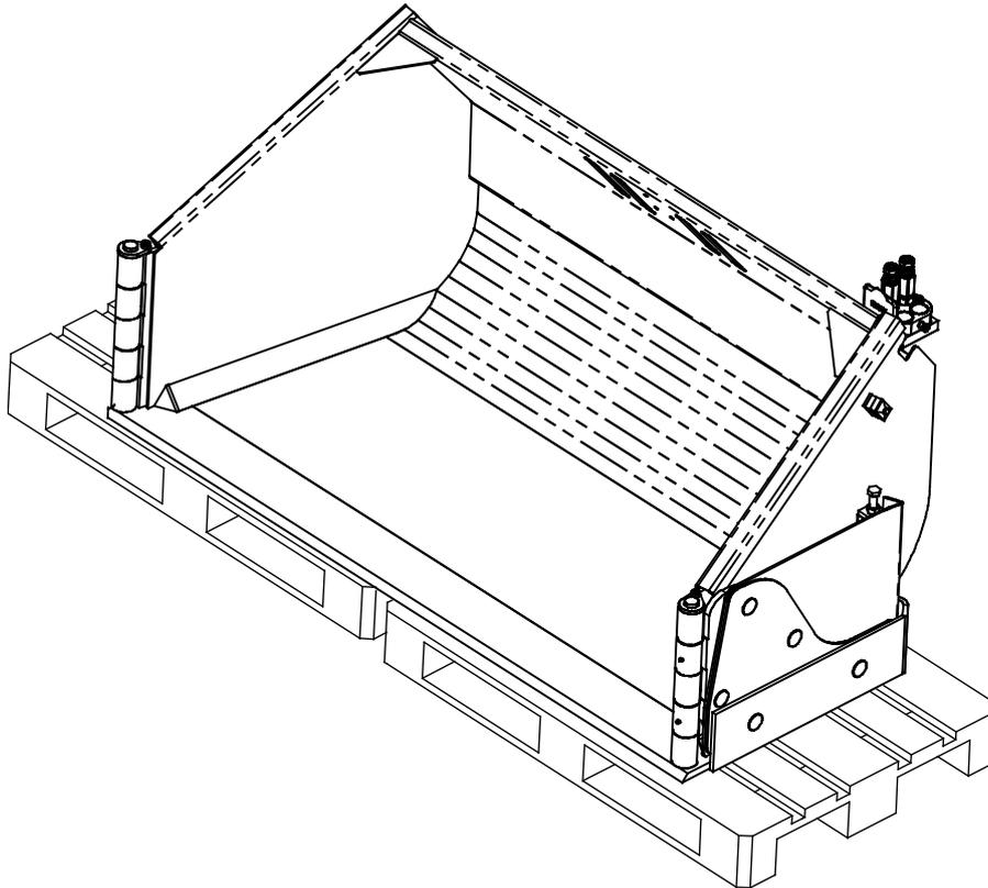
Reinigen Sie das Anbaugerät bei einer längeren Lagerung, bessern Sie im Bedarfsfall den Lack auf, schmieren Sie die Schmierpunkte und ölen Sie die sichtbaren Teile der Hydraulikzylinderschäfte, um Rostschäden zu vermeiden.
